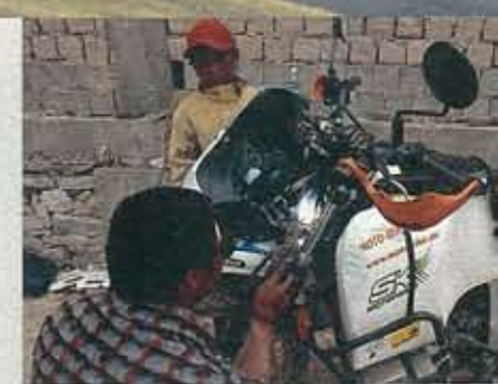
Kleinere Schweißarbeiten an der Verkleidungsaufnahme in Zanskar
